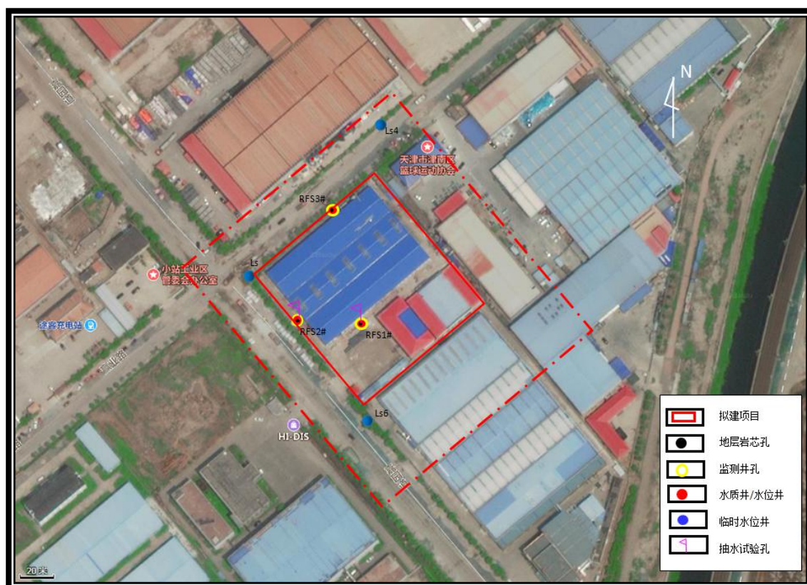
图 6.5-4 野外工作钻探孔、监测井点位分布图
