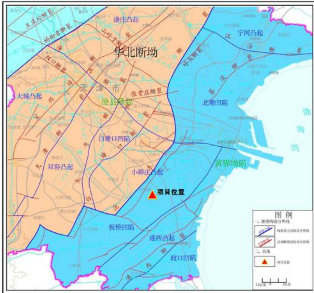
图 4.1-2 项目场地周边构造单元和断裂分布图
