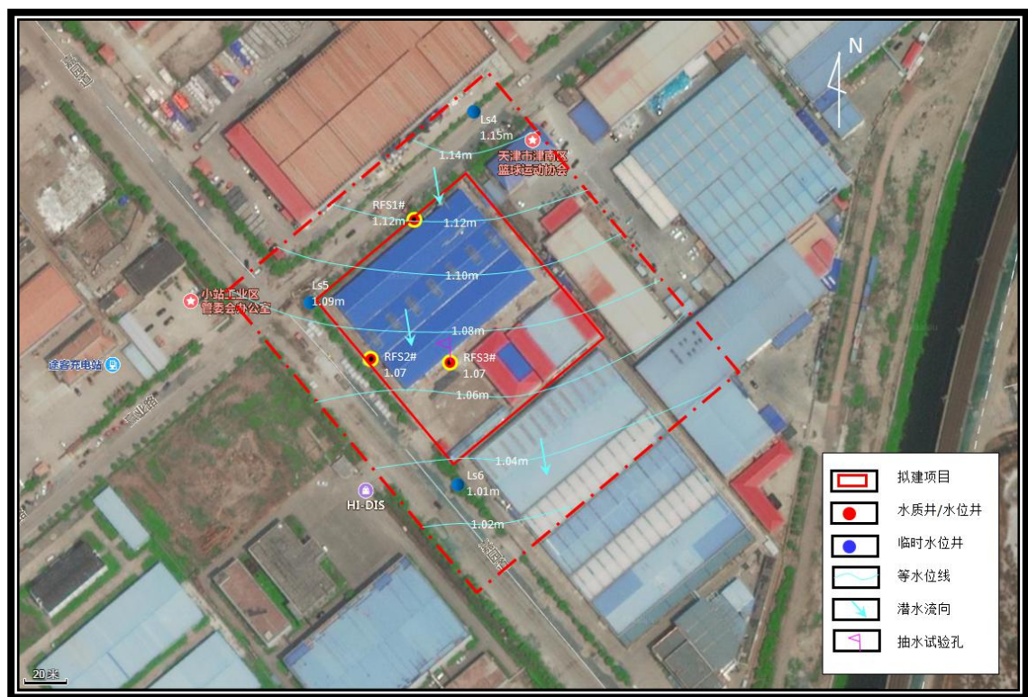
图 6.5-3 场地潜水流场图（2019.12 测）
