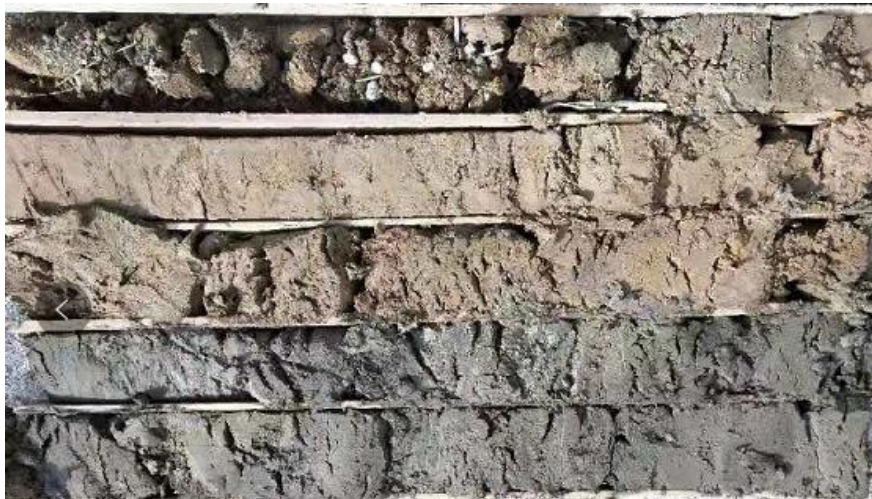
相片 6.5-1 人工填土、海陆过度地层变化
