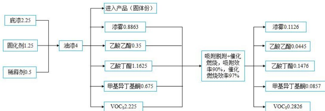
图 5-4 底漆、固化剂、稀释剂物料平衡图 单位：t/a
